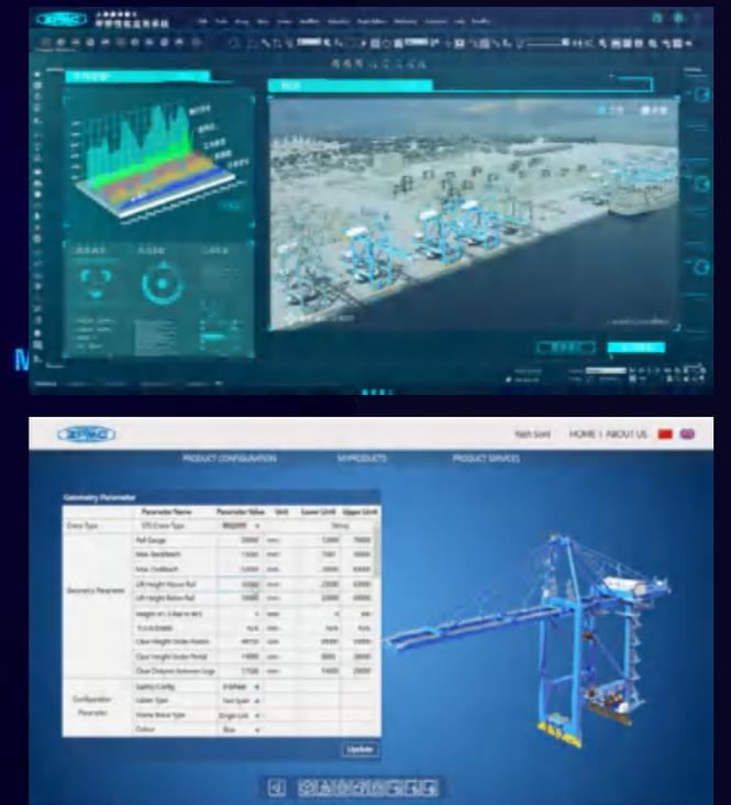
运用“数字孪生”技术定制港机产品的设计制造运维一体化平台。
