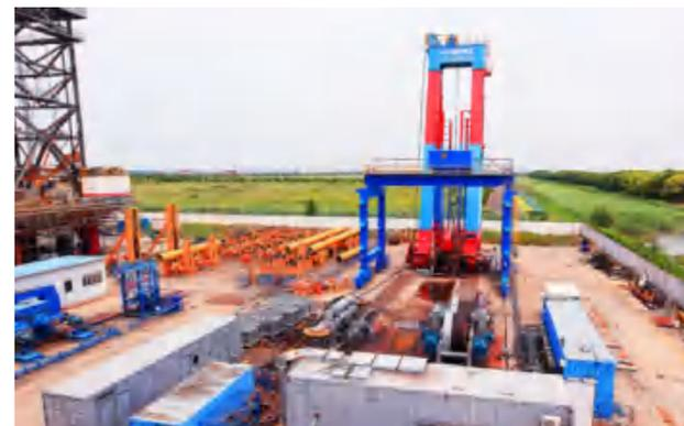
200吨深水波浪补偿绞车系统正在进行工厂试验。
