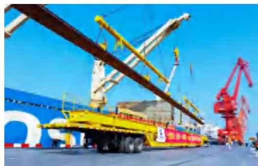
11月28日，北部湾港防城港6号泊位上，7根50米长钢轨缓缓起吊，平稳地铺放在船舱预定货位上，这是印尼雅万高铁钢轨第一码货物装船，也是中国高铁“整体出口”的第一单，对于发挥北部湾国际门户港的作用，服
