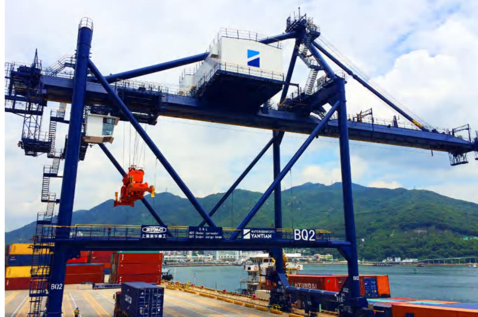
振华重工自主研发的新一代轻量化岸桥。
